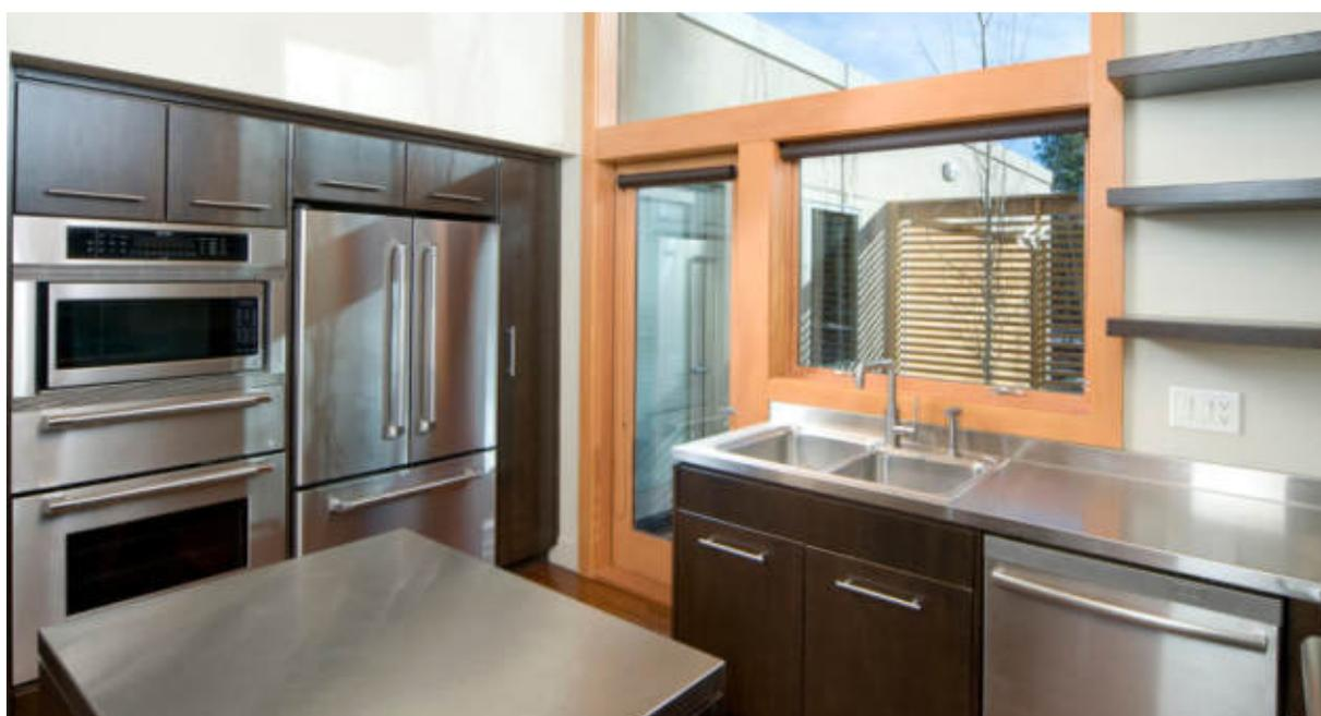
Edelstahlarbeitsplatten mit Auf- und Abkantung sowie zugeschweißten Ecken
